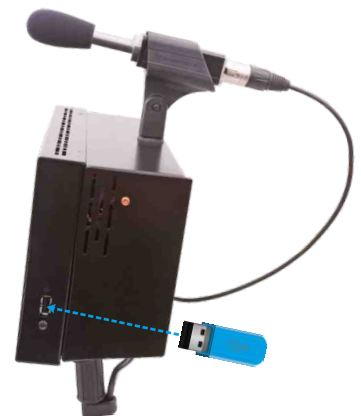
Embase USB permettant le téléchargement de l'historique et la mise à jour de l'afficheur
