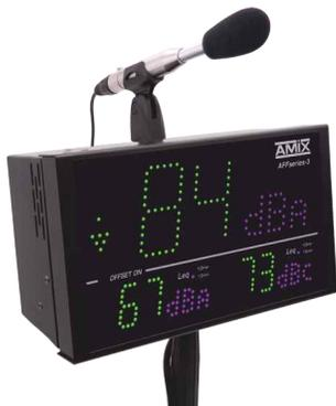
L'AFF65-3 en version Mobility est un afficheur enregistreur de pression acoustique, étudié pour l'utilisation en itinérant. Il peut fonctionner avec un capteur pour une mesure en pondération A et C ou par deux capteurs pour une mesure en pondération A et C séparée.
